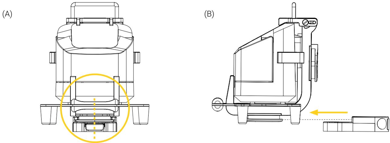
**Figure 15:** Retrait horizontale du support Bracket Pro Serie 61 – GR de la Micro Base
