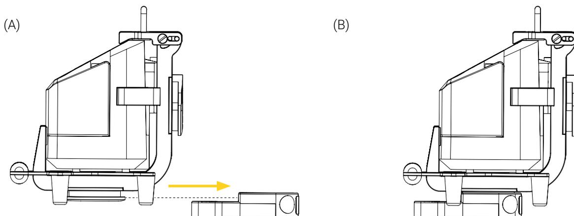
**Figure 12:** Installation horizontale du support Bracket Pro Serie 61 – GR dans la Micro Base
