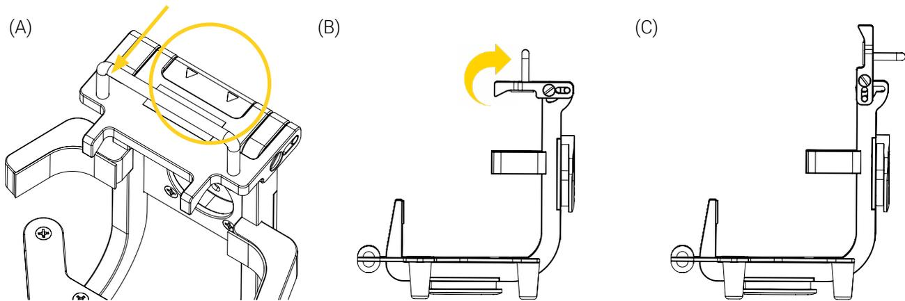
**Figure 5:** Déverrouillage et ouverture du support
