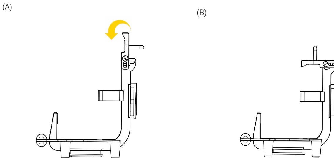
**Figure 10:** Fermeture et verrouillage du support
