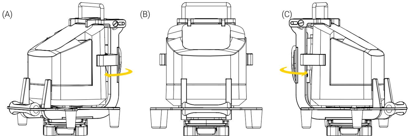
**Figure 13:** Rotation du support Bracket Pro Serie 61 – GR dans la Micro Base
