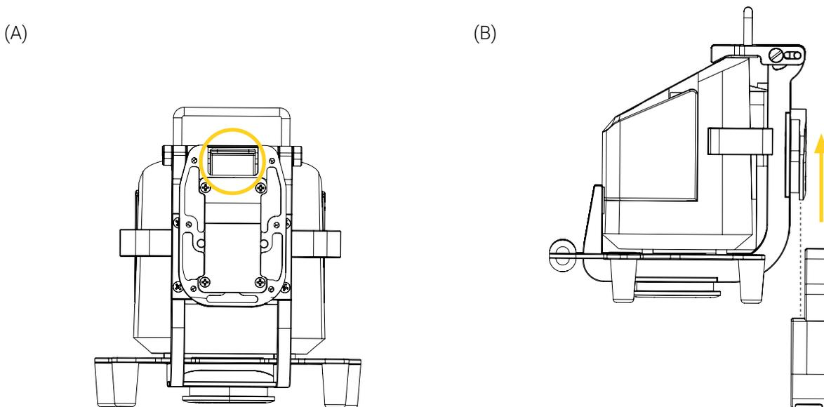
**Figure 14:** Retrait verticale du support Bracket Pro Serie 61 – GR de la Micro Base
